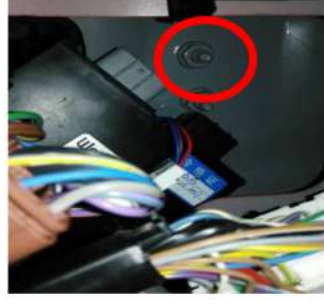
6. Installer le boîtier ECU comme sur l'image ci-dessus - fixez-le à l'aide d'une vis.
