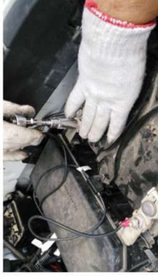
2. Raccorder le faisceau à la batterie : le rouge avec le fusible positif.
