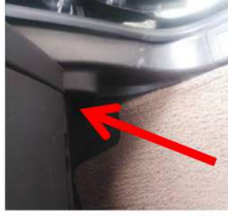
6. Installer le boîtier ECU comme sur l'image ci-dessus - fixez-le à l'aide d'une vis.
